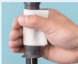
折り戻し部の清掃作業
